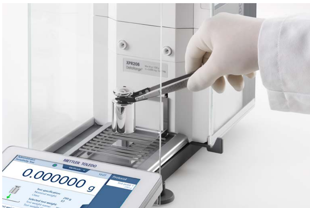
Správna manipulácia so závažiami pomocou pinzety s uhlíkovými špičkami.
