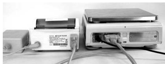
7 Allumez l'imprimante avec l'interrupteur **I/O**.
