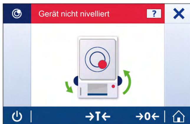
Nach Befolgung der Anweisungen zeigt der Nivellierungsassistent die nächsten Schritte. Befolgen Sie alle Schritte, bis die Waage nivelliert ist.
