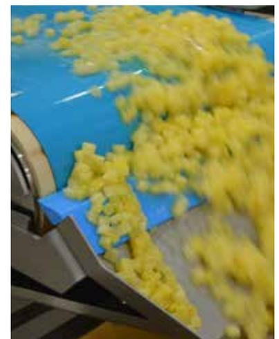
Der Feuchtegehalt der Ananas erschwert auf Grund des Produkteffekts die Inspektion mit herkömmlichen Metallsuchgeräten – Profile Advantage jedoch wurde speziell für Inspektionsanwendungen dieser Art entwickelt.
