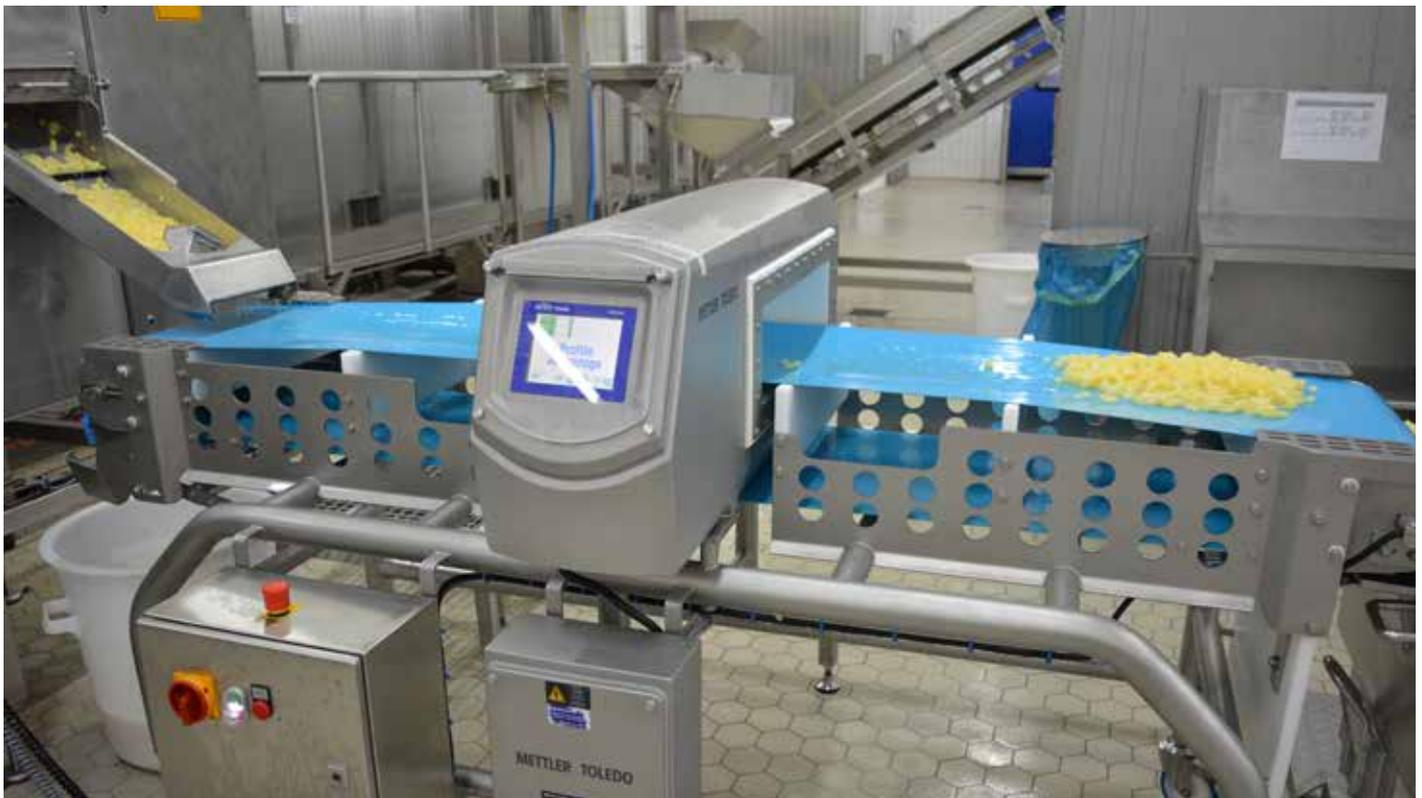
Der Profile Advantage-Metalldetektor wird zur nahtlosen Integration in die Produktionslinie mit einem Transportband kombiniert.
