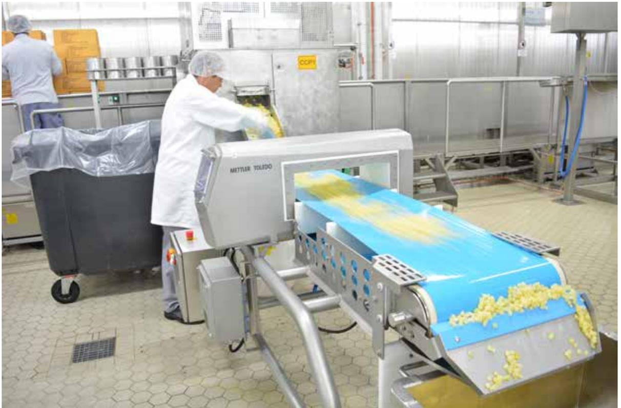
Bei Detektion eines Metallfremdkörpers wird das Produkt mittels Bandreversierung ausgeschleust. Dieses Verfahren erhöht die Prozesssicherheit bei Zentis und schützt die Produkte sowie den Markenruf, indem nur garantiert metallfreie Rohwaren weiterverarbeitet werden.
