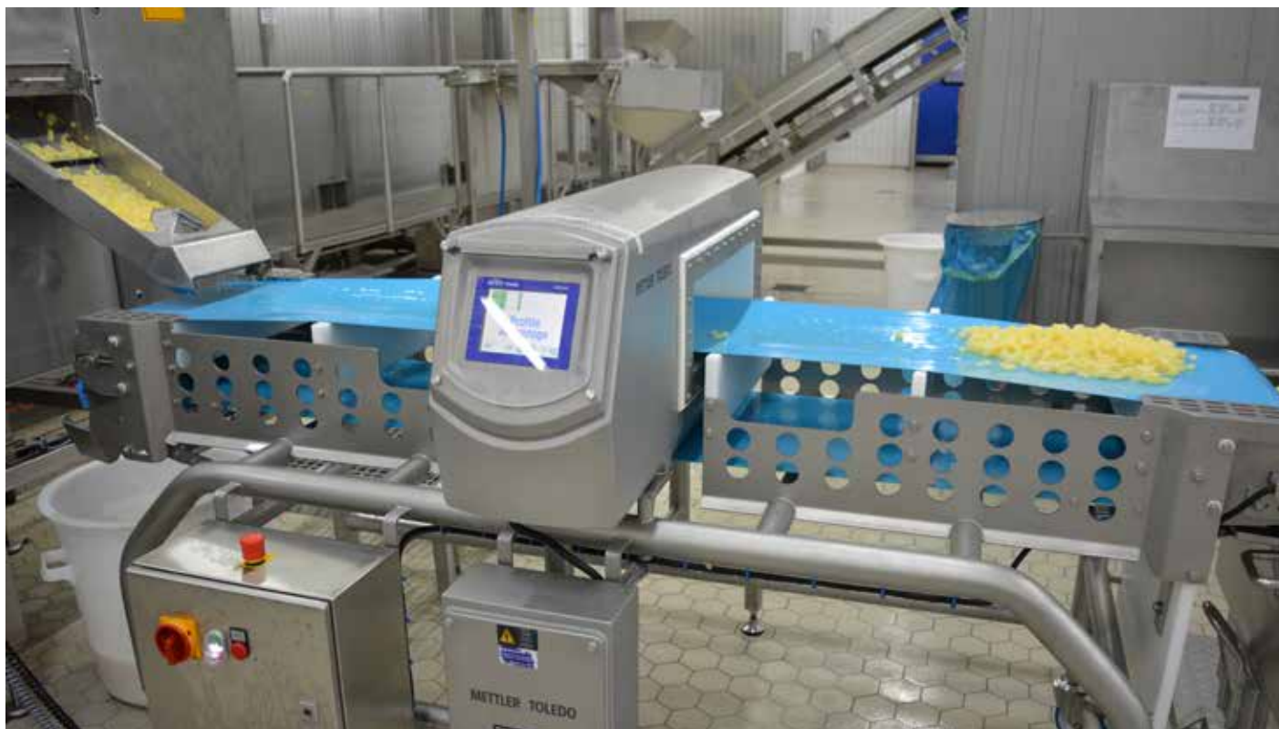
O detector de metais Profile Advantage é combinado com um sistema de esteira transportadora para integração mais fácil na linha de produção.
