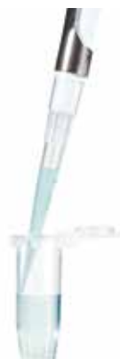
Dozowanie na ściankę naczynia
