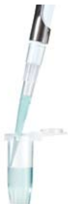
壁面に沿って液切り
