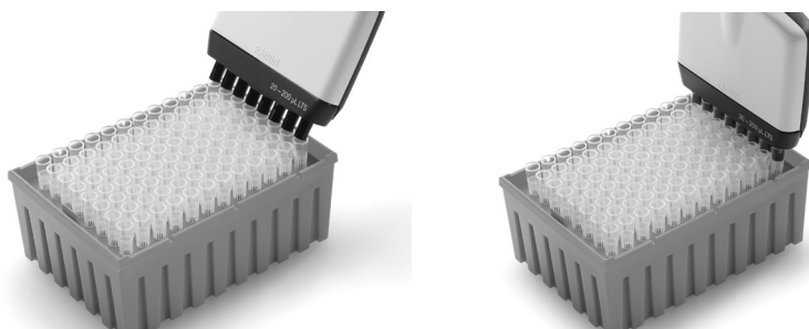
図 14: ラックに入った LTS チップの取り付け
