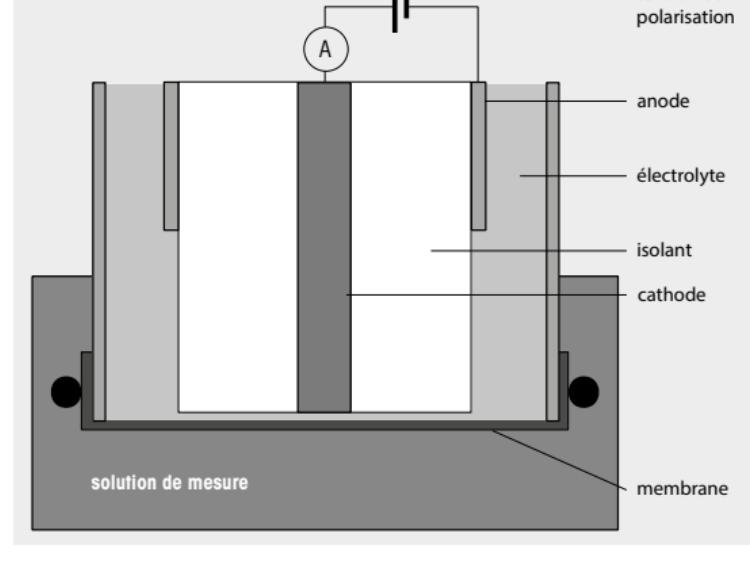
Dans le cas de l'électrode de Clark, la configuration géométrique est très importante. L'épaisseur du film d'électrolyte situé entre la cathode et la membrane doit satisfaire des tolérances très strictes, de manière à garantir une bonne linéarité et un courant de zéro faible (courant dans une atmosphère d'azote). L'image ci-dessus représente une électrode à oxygène de type Clark.
