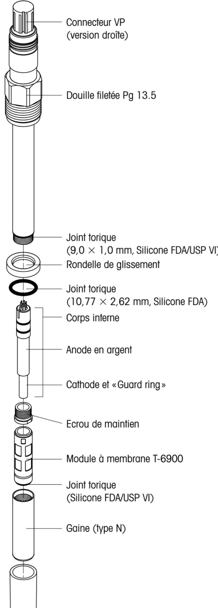
Les sondes O<sub>2</sub> METTLER TOLEDO sont livrées avec module à membrane monté, remplis d'électrolyte et capuchon à liquide placé. Leur fonctionnement a été testé.
