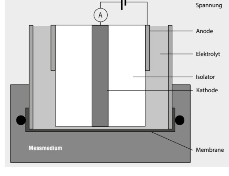
Bei den Clark-Elektroden ist die konstruktive Auslegung sehr wichtig. Speziell die Dicke des Elektrolytfilms zwischen der Kathode und der Membrane muss in sehr engen Grenzen gehalten werden, um eine gute Linearität und einen tiefen Nullstrom (Strom in reinem Stickstoff) zu gewährleisten. Die obenstehende Abbildung zeigt den prinzipiellen Aufbau von Clark-Sauerstoffelektroden.
