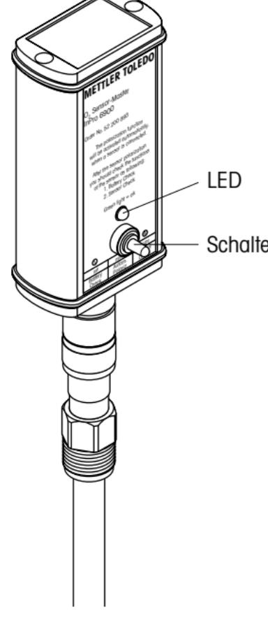
Sobald der Sensor am O<sub>2</sub> Sensor-Master angeschlossen ist, wird automatisch die Polarisierfunktion aktiviert und der Sensor mit der richtigen Polarisationsspannung versorgt. Falls der Sensor für mehr als 5 Minuten vom Transmitter getrennt war, muss er zuerst polarisiert (Polarisationszeiten siehe «Kapitel 5.1») werden, bevor aussagekräftige Testresultate erzielt werden.
