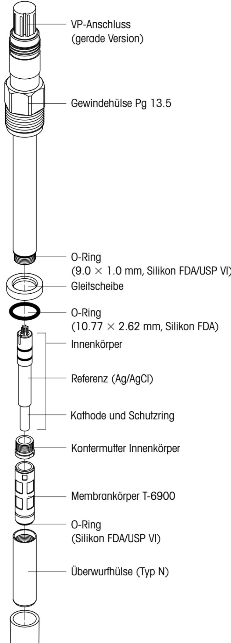
METTLER TOLEDO O<sub>2</sub>-Sensoren werden mit montiertem Membrankörper gefüllt mit Elektrolyt und aufgesteckter Wässerungskappe ausgeliefert und sind auf einwandfreie Funktionsweise geprüft.
