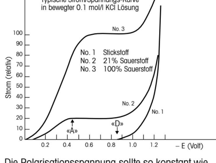
Die Polarisationsspannung sollte so konstant wie möglich sein. Neben einer konstanten Spannungsquelle müssen folgende Voraussetzungen erfüllt werden: Der elektrische Widerstand des Elektrolytfilms darf einen spezifischen Wert nicht überschreiten, damit ein Spannungsabfall verhindert wird.
