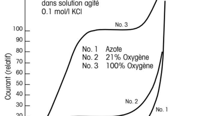
La tension de polarisation doit rester aussi constante que possible. Outre une source de tension constante, les conditions suivantes doivent également être remplies : La résistance électrique du film d'électrolyte ne doit pas dépasser une certaine valeur afin d'éviter une chute de tension.
