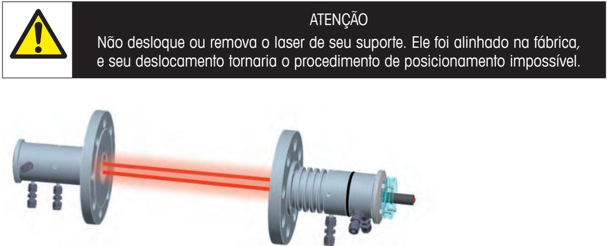
Figura 22 Conexão do ponteiro laser/alvo do modo refletivo à montagem da cabeça TDL.
