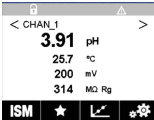
**Ejemplo:** Indicación de advertencia en la parte superior de la pantalla de medición.
