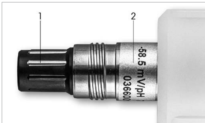
Fig. 1: InSUS pH-sensor (voorbeeld)
