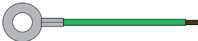
Cavo di messa a terra con capocorda
