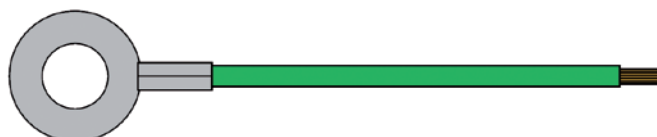
Cable de conexión a tierra con terminal
