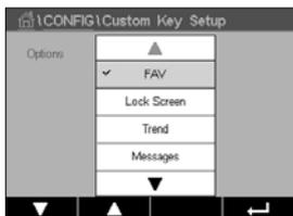
С помощью меню «Custom Key Setup» (Настройка функциональной клавиши) можно настроить пользовательское меню, используя для быстрого доступа к нему вторую слева кнопку на экране меню. Функциональной кнопкой удобно пользоваться, когда отсутствует сенсорный экран.
