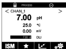
Для индикации аварийных сообщений используется специальный символ, отображаемый в верхней строке экрана.
