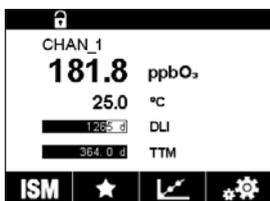
После определения концентрации O<sub>3</sub> нажмите клавишу калибровки, чтобы выполнить калибровку по технологической среде.
