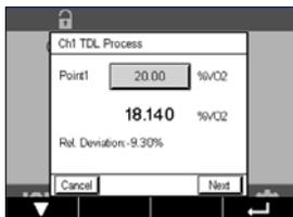
M400 проверит стабильность измеряемого сигнала и продолжит работу, как только сигнал станет достаточно стабильным.
