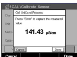
Выполните отбор пробы и нажмите клавишу DONE (Готово), чтобы сохранить в памяти текущее измеряемое значение. Для отображения выполняемой калибровки на дисплее мигает символ «P» в окне запуска и меню, если на экране выбран соответствующий канал.
