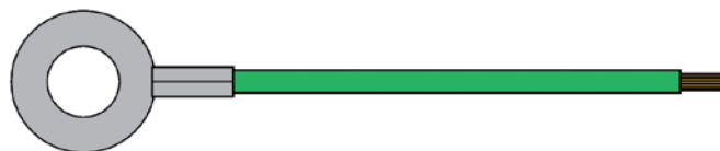
Erdungsanschlusskabel mit Kabelschuh
