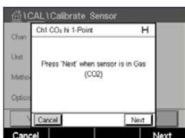
Avec la sonde de conductivité thermique, un étalonnage en un point correspond à un étalonnage de la pente. Appuyez sur le bouton « Cal » pour lancer l'étalonnage.
