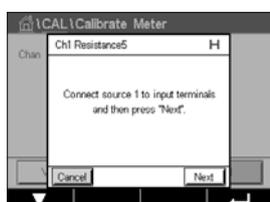
Connectez la source 1 aux terminaux d'entrée. Chaque plage de résistance requiert un étalonnage en deux points.
