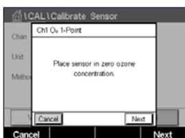
Placez la sonde dans le gaz d'étalonnage (l'air, par exemple), puis appuyez sur le bouton « Next » (Suivant).
