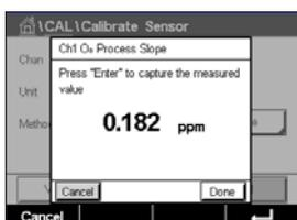
Prélevez un échantillon et appuyez de nouveau sur le bouton  $\leftarrow$  pour mémoriser la mesure actuelle. Un « P » clignotera dans la fenêtre de mesure pour indiquer qu'un étalonnage procédé est en cours.
