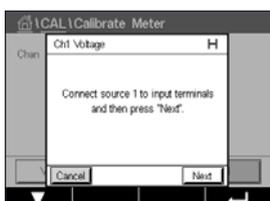
Connectez la source 1 aux terminaux d'entrée. Appuyez sur le bouton « Next » (Suivant) pour lancer l'étalonnage.
