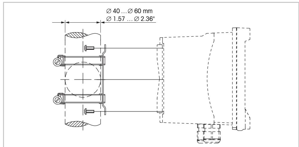
Illustration 8 : Montage sur conduite – modèle ½ DIN
