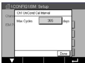
Appuyez sur le champ **Interval Cal** (l'intervalle d'étalonnage) pour saisir l'intervalle d'étalonnage. Le transmetteur calculera la durée avant le prochain étalonnage (TTCal) à partir de cette valeur. Appuyez sur ← pour accepter la valeur. La nouvelle valeur sera transmise à la sonde une fois les modifications enregistrées.
