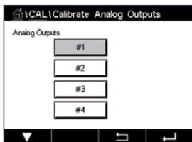
Chaque sortie analogique peut être étalonnée à 4 et 20 mA. Sélectionnez le signal de sortie à étalonner en appuyant sur le bouton #1 pour le signal de sortie 1, le bouton #2 pour le signal de sortie 2, etc.
