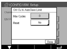
Appuyez sur le champ **Max Cycles** (Cycles Max) pour saisir le nombre maximum de cycles d'autoclavage. La nouvelle valeur sera transmise à la sonde une fois les modifications enregistrées.
