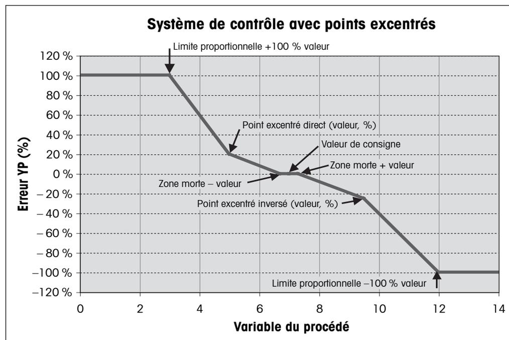
Lisez les explications suivantes pour en savoir plus sur les différents réglages du Contrôleur PID.
