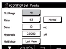
Une fois la configuration terminée, un relais peut être activé si la condition **Out of range** (Hors limite) est détectée sur la voie d'entrée affectée.
