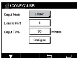
Sélectionnez « Output Mode » (Mode sortie), « Off » (Désactivé), « Printer » (Imprimante) ou « Data Log » (Journal).
