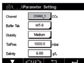
Si une sonde de  $\text{CO}_2$  dissous est connectée alors que le mode Auto ou  $\text{CO}_2$  a été choisi pendant la configuration des voies (voir le chapitre 7.1.1 « Configuration voie » à la page 59), vous pouvez définir ou ajuster le tampon utilisé pour l'étalonnage ainsi que les paramètres « Stability » (Stabilité), « Salinity » (Salinité), «  $\text{HCO}_3$  » et « TotPres » (Pression Tot).
