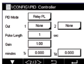
**Mode PID** affecte un relais ou une sortie analogique pour le contrôle du PID. Selon le dispositif de contrôle utilisé, sélectionnez une des trois options proposées (« Relay PL » (Relais Long), « Relay PF » (Relais Freq) et « Aout » (Sortie ana)) en appuyant sur le champ correspondant.
