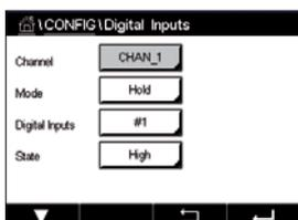
Appuyez sur le champ Mode pour sélectionner le **Mode** d'un signal d'entrée numérique actif. Choisissez « Hold » (Maintien) pour mettre la voie affectée en mode « Hold » (Maintien).
