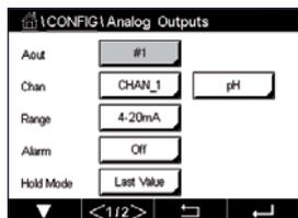
Appuyez sur le champ **Aout** (Sortie ana), puis sélectionnez le signal de sortie que vous souhaitez configurer en appuyant sur #1 pour le signal de sortie 1, #2 pour le signal de sortie 2, etc. Appuyez sur le bouton correspondant pour affecter la voie (**Chan**). Sélectionnez la voie que vous souhaitez associer au signal de sortie.
