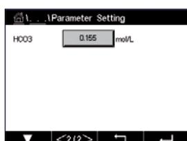
Le paramètre  **$\text{HCO}_3$**  indique la concentration d'hydrogénocarbonate dans l'électrolyte de  $\text{CO}_2$  de la sonde connectée au transmetteur. Il s'agit aussi d'un paramètre spécifique à la sonde. La valeur par défaut (0,050 Mol/L) est valable pour le modèle InPro 5000i. Ne modifiez pas ce paramètre si vous utilisez ce modèle.
