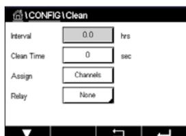
Saisissez le nombre d'heures avant le prochain nettoyage dans **Interval** (Intervalle). L'intervalle de nettoyage peut être compris entre 0,000 et 99 999 heures. Un réglage sur 0 désactive le cycle de nettoyage.
