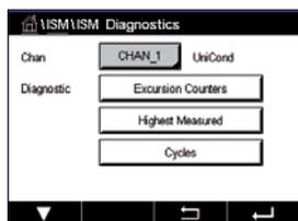
Pour les sondes UniCond 2e et UniCond 4e, les éléments de diagnostic suivants peuvent être consultés : « Compteur dépass » (qui comprend les éléments « High Temp » (Temp élevée) et « High Conductivity » (Conductivité élevée) et « Reset Counters » (Conductivité haute)), « Mesures les plus hautes » (qui comprend les éléments « Temp max » et « Cond max ») et « Cycles » (qui comprend les éléments « Cycles NEP » et « Cycles SEP »).
