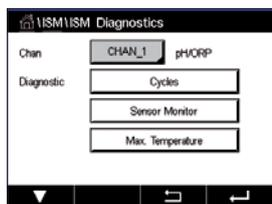
Si une électrode de pH/redox, une sonde à oxygène, à ozone ou Cond4e est connectée, vous pouvez accéder aux menus « Cycles », « Surveill. capteur » et « température Max. ».
