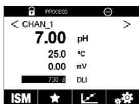
Les alarmes sont indiquées par un symbole d'alarme en haut de l'écran du transmetteur. Un message d'alarme est enregistré et peut être sélectionné via le menu « Messages » (CHEMIN D'ACCÈS : \ISM\Messages ; voir aussi le chapitre 8.2 «Messages»).
