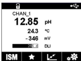
**참고:** 데이터 로그를 시작하기 전에 USB 메모리 스틱이 연결되어 있는지 확인하십시오. USB 기호는 USB 메모리 스틱이 연결될 때 메뉴 화면 상단에 표시됩니다. 호환 가능한 USB 파일 시스템 형식은 FAT 및 FAT32입니다.
