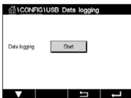
데이터 로그가 구성된 후에(경로: \Config \USB data logging) 데이터 로그를 시작하거나 중지합니다. 또는 사용자 지정 키를 설정해 데이터 로그를 시작하거나 중지할 수 있습니다. (96페이지의 9장 "사용자 지정 키"을 참조하십시오). USB 데이터 로깅의 기본 설정은 "Stop"(정지)입니다.
