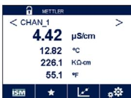
Drücken Sie auf das Eingabefeld für **Point 1** (Punkt 1) und geben Sie den Leitfähigkeitswert der Probe ein. Drücken Sie dann die Schaltfläche «Weiter», um die Ergebnisse für die Kalibrierung zu berechnen.
