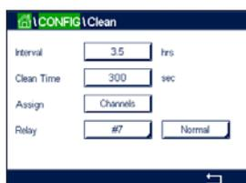
Geben Sie das **Reinigungsintervall** in Stunden ein. Das Reinigungsintervall kann auf 0,000 bis 99 999 Stunden eingestellt werden. Die Einstellung 0 bedeutet, dass der Reinigungszyklus ausgeschaltet ist.
