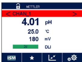
Bedingungen, die einen Alarm auslösen, werden durch einen roten Balken angezeigt. Wenn der betroffene Kanal im aktuellen Menübildschirm oder auf dem Startbildschirm angezeigt wird (siehe Kapitel 3.2 «Anzeige»), erscheint der rote Balken in der Zeile mit der Kanalanzeige. Eine Alarmmeldung wird aufgezeichnet und kann über das Menü «Meldungen» (PFAD: / ISM / Messages; siehe auch Kapitel 9.2 «Meldungen») aufgerufen werden.
