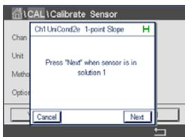
Tauchen Sie den Sensor in die Referenzlösung und drücken Sie die Schaltfläche Weiter.
