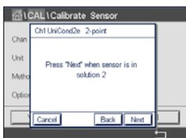
Tauchen Sie den Sensor in die zweite Referenzlösung und drücken Sie die Schaltfläche Weiter.
