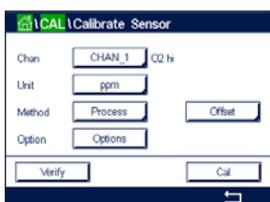
Wählen Sie Steilheit oder Offset für die Kalibrierung durch Drücken der entsprechenden Schaltfläche.
