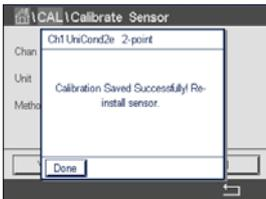
Wurde «Kal. speichern» ausgewählt, wird «Kalibrierung erfolgreich gespeichert» angezeigt. In jedem Fall wird die Meldung «Please re-install sensor» (Bitte Sensor neu installieren) angezeigt. Nach Drücken der Schaltfläche Fertig kehrt der Transmitter zum Kalibriermenü des Sensors zurück.
