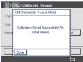
Wurde «Kal. speichern» ausgewählt, wird «Kalibrierung erfolgreich gespeichert» angezeigt. In jedem Fall wird die Meldung «Please re-install sensor» (Bitte Sensor neu installieren) angezeigt. Nach Drücken der Schaltfläche Fertig kehrt der Transmitter zum Kalibrieremenü des Sensors zurück.
