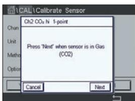
Bei Wärmeleitfähigkeitssensoren erfolgt eine Einpunktkalibrierung stets als Kalibrierung der Steilheit. Drücken Sie die Schaltfläche «Kal.», um die Kalibrierung zu starten.
