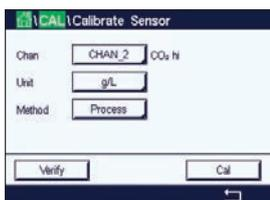
Bei Wärmeleitfähigkeitssensoren erfolgt eine Prozesskalibrierung stets als Kalibrierung der Steilheit.
