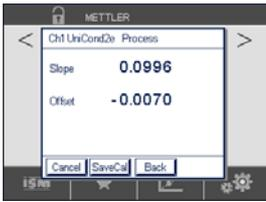
Als Ergebnis der Kalibrierung wird in der Anzeige der Wert für Steilheit und Nullpunktverschiebung (Offset) angezeigt.
