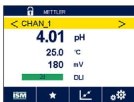
Bedingungen, die eine Warnung auslösen, werden durch einen gelben Balken angezeigt. Wenn der betroffene Kanal im aktuellen Menübildschirm oder auf dem Startbildschirm angezeigt wird (siehe Kapitel 3.2 «Anzeige»), erscheint der gelbe Balken in der Zeile mit der Kanalbezeichnung. Eine Warnmeldung wird aufgezeichnet und kann über das Menü «Meldungen» (PFAD: / ISM / Messages; siehe auch Kapitel 9.2 «Meldungen») aufgerufen werden.
