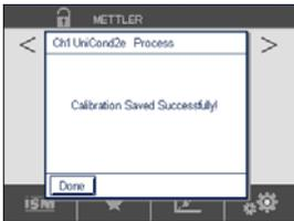
Wurde «Kal. speichern» ausgewählt, wird «Kalibrierung erfolgreich gespeichert» angezeigt. Nach Drücken der Schaltfläche Fertig kehrt der Transmitter zum Menübildschirm zurück.
