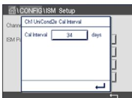
Drücken Sie das Eingabefeld neben **Kal.intervall** und geben Sie den Wert für das Kalibrierintervall ein. Anhand dieses Wertes berechnet der Transmitter die verbleibende Zeit bis zur nächsten Kalibrierung (TTCal). Mit der  $\leftarrow$ -Taste übernehmen Sie den Wert. Der neue Wert wird nach Übernahme der Änderungen im Sensor gespeichert.
