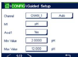
Wählen Sie den gewünschten **Kanal** für das geführte Setup sowie – in derselben Zeile – den Parameter.
