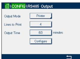
Zum Konfigurieren der Druckerausgabe wählen Sie unter «Output-Modus» (Ausgabemodus) die Option «Drucker». Verfügbar sind die folgenden Optionen:
