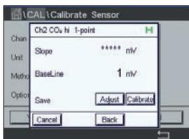
Als Ergebnis der Kalibrierung werden in der Anzeige der Wert für Steilheit und die Basislinie angezeigt. Drücken Sie die Schaltfläche "Adjust" (Justieren), um die Justierung durchzuführen und die berechneten Werte im Sensor abzuspeichern. Drücken Sie die Schaltfläche "Calibrate" (Kalibrieren), um die berechneten Werte im Sensor abzuspeichern.. Eine Justierung wird nicht durchgeführt. Drücken Sie "Cancel" (Abbrechen), um die Kalibrierung abzubrechen.
