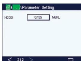
Der Parameter **HCO<sub>3</sub>** gibt die Konzentration des Hydrogencarbonats im CO<sub>2</sub>-Elektrolyten des an den Transmitter angeschlossenen Sensors an. Dieser Parameter ist ebenfalls sensorspezifisch. Der voreingestellte Wert von 0,050 mol/l gilt für den Sensor InPro 5000i. Diesen Parameter keinesfalls ändern, wenn der InPro 5000i verwendet wird.
