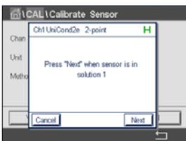
Tauchen Sie den Sensor in die erste Referenzlösung und drücken Sie die Schaltfläche Weiter.
