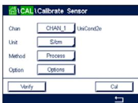
Nehmen Sie eine Probe und drücken Sie die  $\leftarrow$ -Taste, um den aktuellen Messwert zu speichern. Die laufende Kalibrierung wird mit einem blinkenden P auf dem Startbildschirm und im Menübildschirm angezeigt, wenn der entsprechende Kanal in der Anzeige gewählt wurde.
