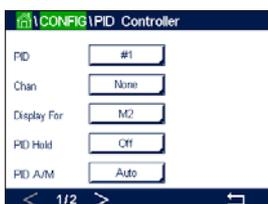
Der M800 Profinet- oder Ethernet/IP-Transmitter bietet zwei PID-Regler. Drücken Sie das Eingabefeld in der Einstellungszeile für **PID** und wählen Sie den zu konfigurierenden PID-Regler durch Drücken der entsprechenden Schaltfläche («#1» für PID-Regler 1 und «#2» für PID-Regler 2).
