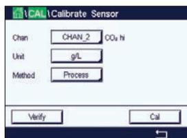
熱伝導率センサでは、プロセス校正が常にスロープ校正として実施されます。
