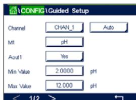
パラメータと同じ行にあるフィールドで、ガイドセットアップを実施するチャンネルを選択します。
