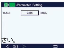
パラメータ**HCO<sub>3</sub>**、変換器に接続されたセンサのCO<sub>2</sub>電解液に溶解している炭酸水素の濃度を示します。これもセンサ固有のパラメータです。初期設定値0.050 Mol/LはInPro 5000iで有効です。InPro 5000iを使用する場合、パラメータを変更しないでください。
