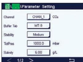
AutoまたはCO<sub>2</sub>がチャンネル設定時に (第8.1.1章「チャンネルセッテイ」を参照) 選択されていて、溶存炭酸ガスセンサが選択したチャンネルに接続されている場合、校正に使用する標準液ならびにパラメータ安定性、Salinity、HCO<sub>3</sub>、TotPresといったパラメータを設定あるいは調整できます。調整済みDLI。
