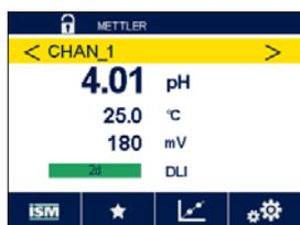
警告が発生した状況が存在する場合、ディスプレイ上の黄色のバーによって通知されます。対応するチャンネルが現在のメニュー画面や開始画面に表示される場合(第3.2章「ディスプレイ」を参照)、黄色のバーがチャンネル名と共に表示されます。警告メッセージは記録されて、「メッセージ」メニューを介して選択できます(パス: 𠂇 / ISM / メッセージ、第9.2章「メッセージ」も参照)。
