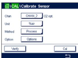
「校正」ボタンを押して、校正を開始します。
