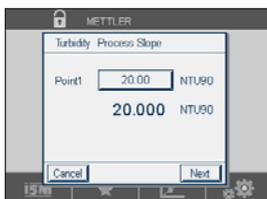
**1点目**の入力フィールドを押して、サンプルの濁度値を入力します。「次へ」ボタンを押して校正結果の計算を開始します。
