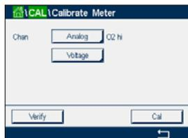
ソース 1 を入力端子に接続します。「次へ」ボタンを押して校正プロセスを開始します。
