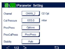
Autoがチャンネル設定時に(第8.1.1章「チャンネルセッテイ」を参照)選択されていて、光学式O<sub>2</sub>センサが選択したチャンネルに接続されている場合、CalPressure、ProcPressure、ProcCalPress、Stability、Salinity、RelHumidity、Sample Rate、LED ModeおよびToffといったパラメータを設定あるいは調整できます。チャンネル設定中にAutoではなくてOptical(光学式)O<sub>2</sub>が設定された場合、同じパラメータが表示されます。
