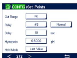
設定が完了して、割り当てた入力チャンネルでセンサの「**範囲外**」状態が検出されると、リレーを作動できます。
