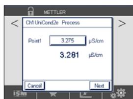
1点目の入力フィールドを押して、サンプルの導電率を入力します。「次へ」ボタンを押して校正結果の計算を開始します。
