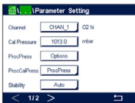
「自動」がチャンネル設定時に(第8.1.1章「チャンネルセッテイ」を参照)選択されていて、ポーラログラフ式O<sub>2</sub>センサが選択したチャンネルに接続されている場合、「校正圧力」「プロセス圧力」「プロセス校正圧力」「安定性」「塩分」「相対湿度」「分極電圧(測定)」「分極電圧(校正)」といったパラメータを設定あるいは調整できます。チャンネル設定中にAutoではなくてO<sub>2</sub> hi、O<sub>2</sub> loまたはO<sub>2</sub>が設定された場合、同じパラメータが表示されます。
