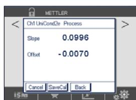
ディスプレイに、校正結果としてスロープとオフセットの値が表示されます。
