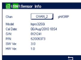
センサが接続されている最初のチャンネルのデータが画面に表示されます。Chanの行にある入力フィールドを押します。希望するセンサのデータを取得するには、適切なフィールドを押すことで対応チャンネルを選択します。
