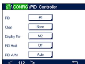
M800 Profinetまたはイーサネット/IP変換器は2つのPIDコントローラを搭載しています。**PID**の設定行にある入力フィールドを押して、PIDコントローラ1用の#1ボタン、PIDコントローラ2用の#2ボタンを押すことで、設定を希望するPIDコントローラを選択します。
