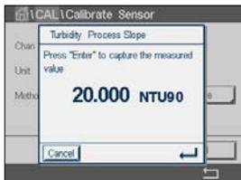
サンプルを取得し、**↵**ボタンを押して、現在の測定値を保存します。校正プロセスが実行されていることを示す目的で、ディスプレイ上の関連チャンネルが選択されている場合、開始およびメニュー画面でPが点滅します。
