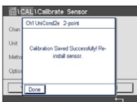
“SaveCal”を選択すると、“Calibration Saved Successfully!”(校正は正常に保存されました)というメッセージが表示されます。いずれの場合でも、“Please re-install sensor”というメッセージが表示されます。Doneボタンを押すと、変換器はセンサの校正メニューに戻ります。
