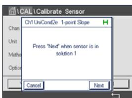
電極を標準液に浸し、「次へ」ボタンを押します。
