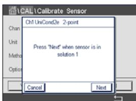
電極を最初の標準液に浸し、「次へ」ボタンを押します。
