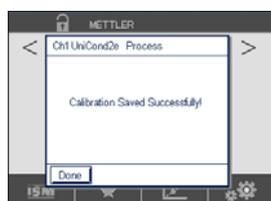
“SaveCal”を選択すると、“Calibration Saved Successfully!”(校正は正常に保存されました)というメッセージが表示されます。Doneボタンを押すと、変換器はメニュー画面に戻ります。
