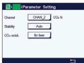
校正手順の間に測定信号の必要とされる**Stability**(安定性)を選択します。校正を完了させるのに十分な位信号が安定しているタイミングをユーザーが決定する場合、「手動」を選択してください。変換器の校正の間にセンサ信号の自動安定コントロール機能が実施する場合、自動を選択します。
