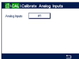
それぞれのアナログ入力は、4mAと20 mAで校正されます。#1 ボタンを押して、校正用の入力信号を選択します。
