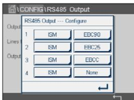
出力時間と送信する測定を設定したら、Configure (設定) ボタンを押して、出力の書式設定を行います。ウィンドウの左側にある数は、出力に表示される行の順番を示します。最初のドロップダウンから、センサを接続するチャンネルを選択します。このドロップダウンには、「チャンネル設定」で設定される各チャンネルに関連付けられているラベルが表示されます。2番目のドロップダウンを用いて、表示される測定に関連付けられる単位を選択します。4行を超える出力を選択した場合は、<and> アイコンを用いて設定するページに進みます。
