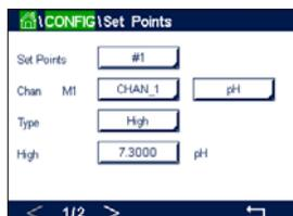
**セットポイント**の設定行にある入力フィールドを押して、セットポイント1用のボタン#1、セットポイント2用の#2、その他を押すことで、希望するセットポイントを選択します。
