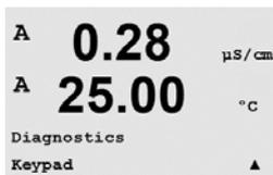
キーパッドの診断については、ディスプレイで押されたキーを表示します。[ENTER]を押すと、変換器は通常の測定モードに戻ります。
