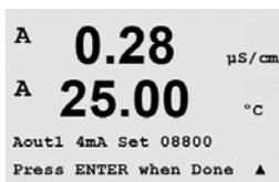
5桁の数字が大きくなると出力電流も増えます。反対に数字が小さくなると出力電流も減ります。一方、千桁目や百桁目を変更すると、出力電流は大きく変更されます。十桁目や一桁目を変更すると、より細かく変更できます。
