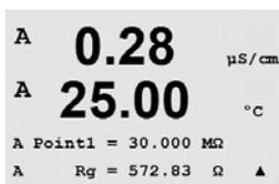
pHガラス電極の入力に接続した抵抗にしたがって、ポイント1に校正値を入力します。[ENTER]を押すと、校正プロセスが始まります。
