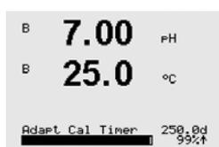
適応式校正タイマ: このタイマでは、適用する校正タイマが表示されます。ベストな測定を実施し続けるために次の校正を実行します。適応式校正タイマは日数 (日) とパーセンテージ (%) で示されます。適応式校正タイマの詳細については、8.6章「ISMセットアップ」を参照してください。
