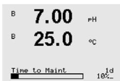
メンテナンスマデ: このタイマでは、[メンテナンスマデ]が表示されます。ベストな測定を実施し続けるために次のクリーニングを行います。適用するメンテナンスマデは日数 (日) とパーセンテージ (%) で示されます。メンテナンスタイマの詳細については、8.6章「ISM セットアップ」を参照してください。O<sub>2</sub>センサにおいては、メンテナンスタイマは、膜と電解液のメンテナンスの周期を示されます。
