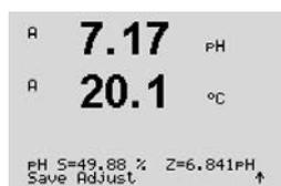
安定基準が満たされるとディスプレイ上に、スロープ校正ファクタのSとオフセット校正ファクタのZが表示されます。
