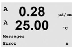
最新のメッセージが表示されます。上下の矢印キーを使用して、最後から4つの発生したメッセージにスクロールできます。
