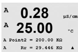
pH比較電極の入力に接続した抵抗にしたがって、ポイント2に校正値を入力します。
