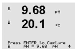
サンプルを取得し、[ENTER]キーをもう一度押して、現在の測定値を保存します。校正プロセス中を示すために、「A」または「B」(チャンネルに応じて)がディスプレイで点滅します。
