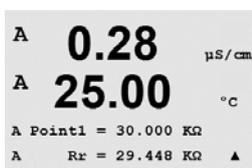
pH比較電極の入力に接続した抵抗にしたがって、ポイント1に校正値を入力します。[ENTER]を押すと、校正プロセスが始まります。
