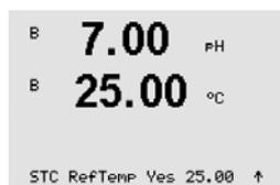
**STC RefTemp**は、温度補正が参照する温度を設定します。表示される値と出力信号はSTC RefTempに対する参照値となります。“No”の選択は、温度補正は使用されないことを意味します。最も一般的な基準温度は25°Cです。[ENTER]を押します。
