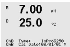
センサに関する以下の情報がこのメニューに表示されます。上下の矢印のキーでメニューをスクロールします。
