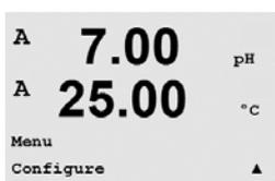
測定モード中に◀ キーを押します。▲ または ▼ キーを押して[コンフィギュレーション]-[メニュー]に進み、[ENTER]を押します。
