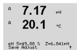
ディスプレイに、スロープ校正ファクタのSとオフセット校正ファクタのZが表示されます。
