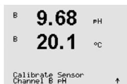
7.1章「校正モードを入力します」で示したようにpH校正モードを入力します。
