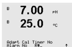
**適応式校正タイマの起動:** このタイマは、最適な測定を継続するために次の校正時期を推定します。タイマにはDLIパラメータの大きな変化が影響します。
