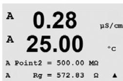
pHガラス電極の入力に接続した抵抗にしたがって、ポイント2に校正値を入力します。
