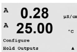
「シュツリョクヲホールド」機能は、校正の実行中に適用されます。校正を実行中に出力ホールド[シュツリョクヲホールド]を[Yes]に設定すると、アナログ出力とオープンコレクター(OC)出力がホールド状態になります。ホールド状態は設定によって異なります。次のリストにホールドの設定を示します。次のオプションが利用できます。
