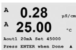
正確なミリアンペアメータをアナログ出力端子に接続してミリアンペアメータで4.00 mAを表示するまで5桁の数字を調整していきます。20.00 mAも同様に操作して調整していきます。
