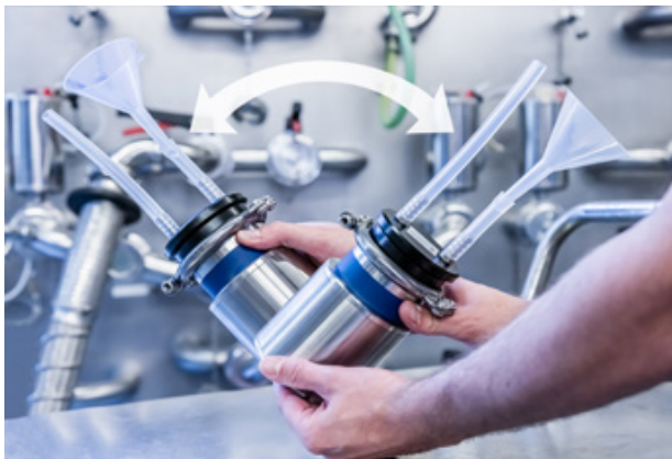
前后倾斜传感器约 45° 以排出装置内的气泡
