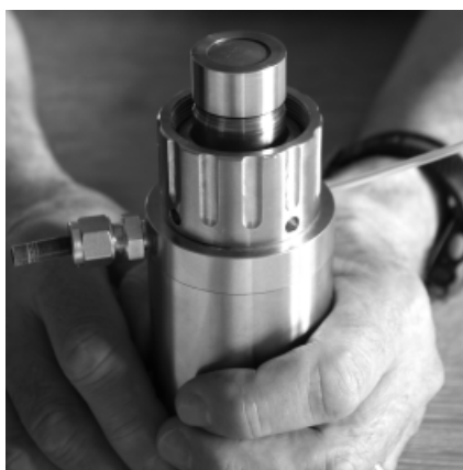
Fig.1 : Maintenez la sonde la tête en bas pendant la maintenance, par exemple, le changement de MembraCap
