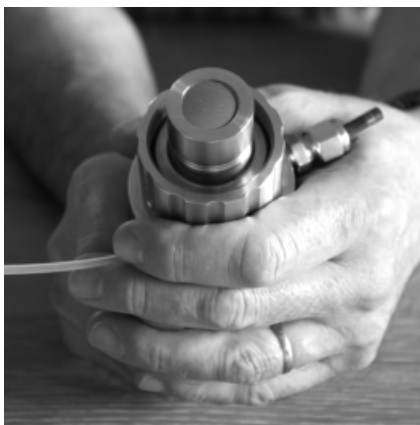
Abb. 7: Sensor mit neuer MembraCap, bereit zur Kalibrierung
