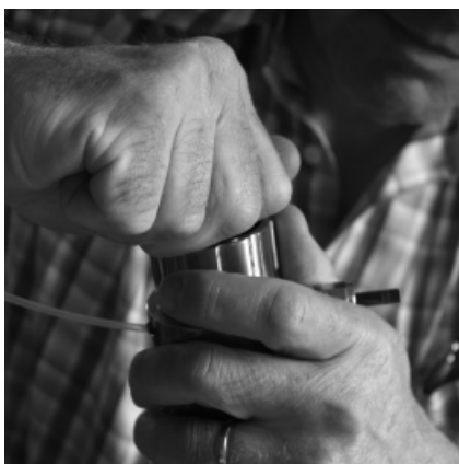
Abb. 6: Neue MembraCap aufschrauben
