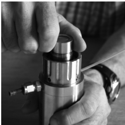
Abb. 4: MembraCap entgegen dem Uhrzeigersinn abschrauben
