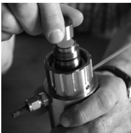
Abb. 5: Neue MembraCap oben am Sensor anbringen
