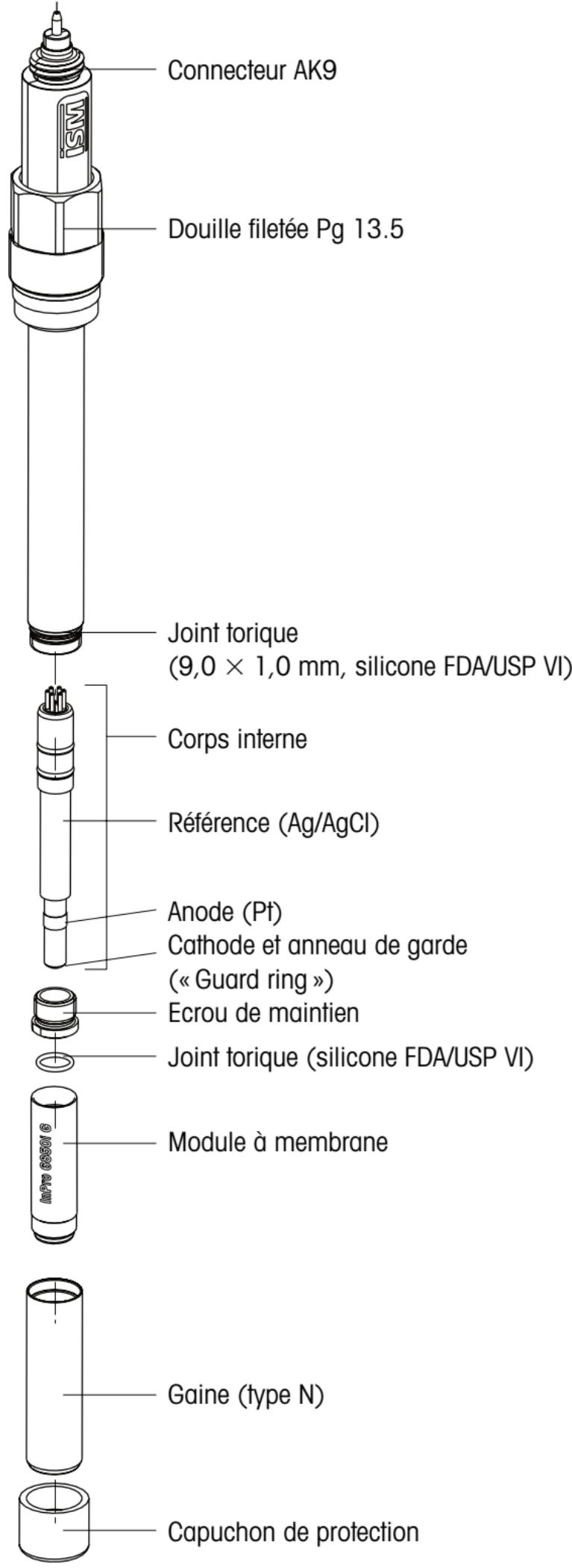
Les sondes O<sub>2</sub> ISM METTLER TOLEDO sont livrées avec module à membrane monté, sans électrolyte et avec capuchon de protection placé. Leur fonctionnement a été testé.
