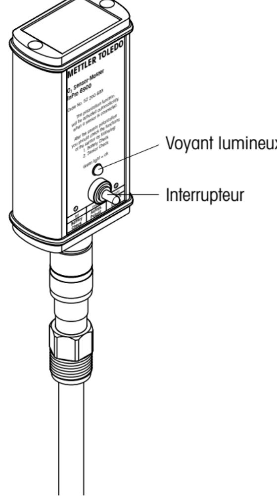
La fonction de polarisation est activée dès la connexion de la sonde au polarisateur O<sub>2</sub>. Si la sonde a été débranchée du transmetteur pendant plus de 5 minutes, polarisez la sonde (temps de polarisation, voir « Chapitre 5.1 ») afin d'obtenir des résultats de test représentatifs.
