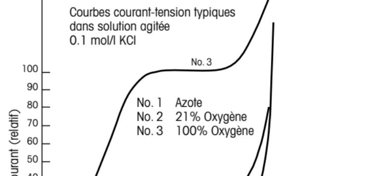
La tension de polarisation doit rester aussi constante que possible. Outre une source de tension constante, les conditions suivantes doivent également être remplies : La résistance électrique du film d'électrolyte ne doit pas dépasser une certaine valeur afin d'éviter une chute de tension.
