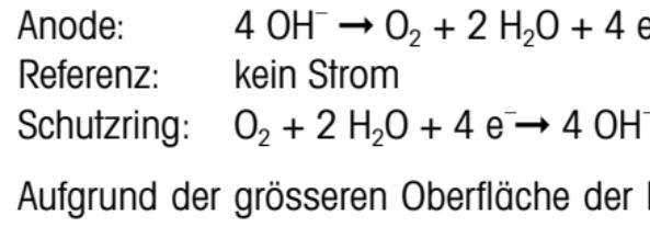
Aufgrund der grösseren Oberfläche der Kathode ent- stehen grössere Ströme während der Messung. Dies ermöglicht die Messung von Sauerstoffkonzentra- tionen unterhalb von 1 ppb.
