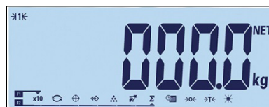
Abbildung 3-25: Anzeige nach dem automatischen Trieren
