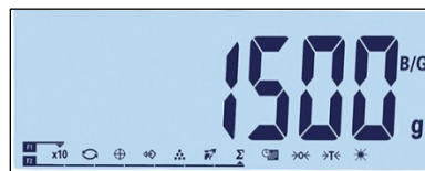
Abbildung 3-32: Anzeige der zweiten Maßeinheit
