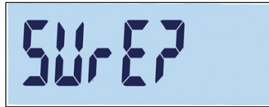
Abbildung 3-68: Bestätigungsaufforderung zum Zurücksetzen des Blocks COM1-Kommunikation
