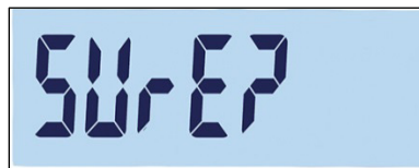
Abbildung 3-55: Bestätigungsaufforderung zum Zurücksetzen des Anwendungsblocks
