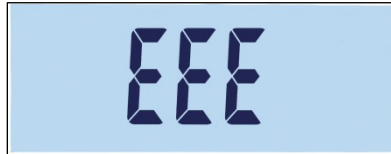
Abbildung 3-21: Warnmeldung bei der Erfassung des Nullwerts bei OIML
