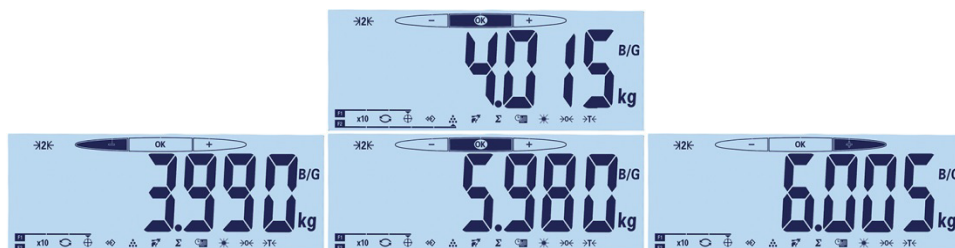
Abbildung 2-13: Anzeige für Über, OK und Unter
