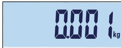
Abbildung 3-13: Schrittweite des Bereichs 1
