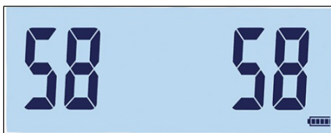
Abbildung 4-5: Bildschirm „Serieller Test“ – Daten übertragen (links) und empfangen (rechts)
