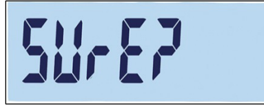
Abbildung 3-36: Bestätigungsaufforderung zum Zurücksetzen des Waagenblocks
