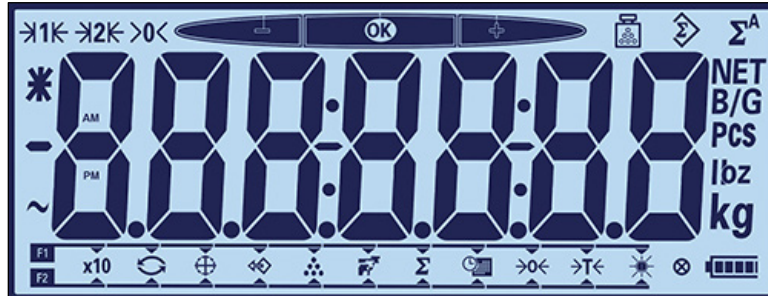
Abbildung 3-70: Anzeigetest, alle LCD-Segmente angezeigt
