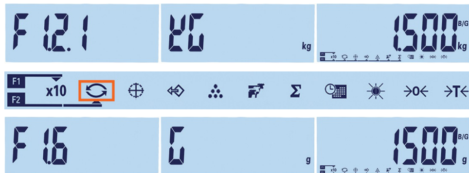
Abbildung 2-7: Umschalten der Maßeinheit: Kilogramm in Gramm
