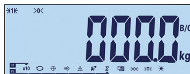
Abbildung 3-27: Anzeige nach dem automatischen Löschen des Tarawertes
