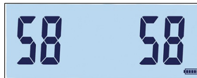
Abbildung 3-71: Bildschirm für den seriellen COM1-Test
