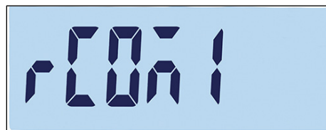
Abbildung 2-8: Waagentypeinstellung für Fernfunktion
