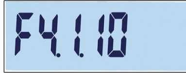
Abbildung 3-67: Bildschirm zum Zurücksetzen des COM1-Kommunikationsmenüs
