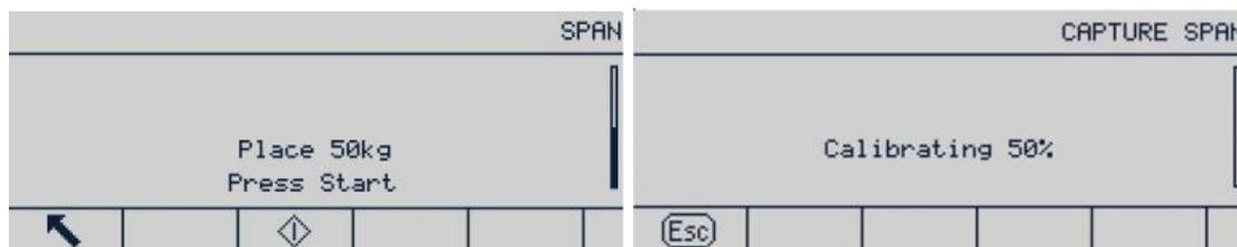
**Abbildung 3-15: Messspannenkalibrierung wird durchgeführt**
