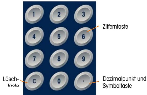
**Abbildung 2-5: Aufbau des Zifferntastefelds**
