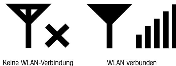
**Abbildung 2-9: WLAN-Statusanzeige**
