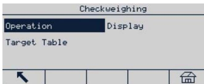
**Abbildung 3-57: Konfigurationsmenü der Prüfwäganwendung**
