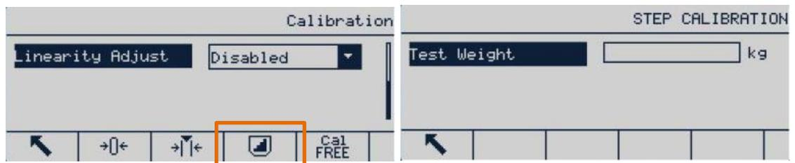
**Abbildung 3-21: Aufrufen der schrittweisen Kalibrierung**
