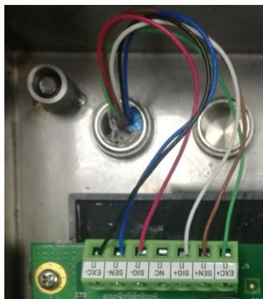
Abbildung 4-3: Anschluss der analogen Wägezelle
