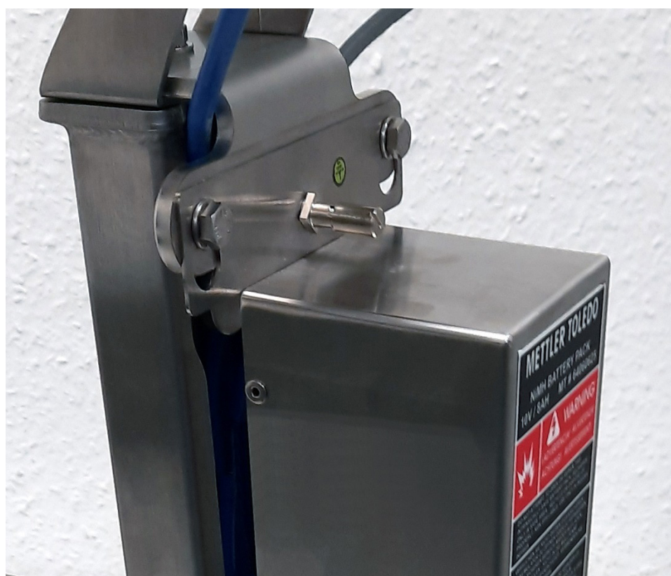
Figure 3-4 : Support de montage de la batterie, installé
