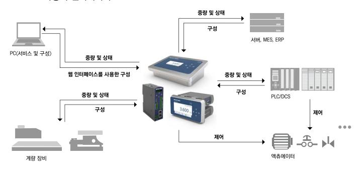
IND360은 다양한 유형의 계량 장비를 PLC 또는 DCS와 같은 자동화 제어 장치와 서버, MES 또는 ERP 시스템에 OPC UA 또는 REST API를 사용하여 연결합니다. 또한 액츄에이터의 출력을 직접 가동시키고 스위치로부터 입력을 수신하는 계량 Application 에 대한 관리 기능을 제공합니다. 보다 자세한 내용은 IND360 매뉴얼을 참조하십시오. IND360은 Microsoft Edge 또는 Google Chrome과 같은 웹 브라우저를 통해 접속하는 웹 인터페이스를 사용해 매우 쉽게 설치할 수 있습니다.
