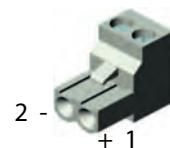
Un connecteur approprié doté de bornes d'alimentation à vis est fourni (connecteur de type MSTB 2.5/2-ST-5.08). Le diamètre de câble adapté est compris entre 0,2 mm<sup>2</sup> et 2,5 mm<sup>2</sup> (AWG 24 à AWG 12).
