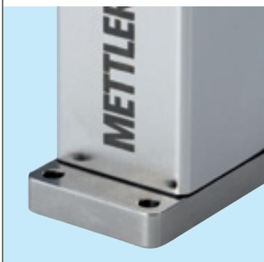
La struttura in acciaio inossidabile lucidato 316 L (1.4404) e tutte le guarnizioni sono conformi FDA. Il modulo di pesata è dotato di flange forate che consentono di agganciarlo all'interno di macchinari e strumenti.
