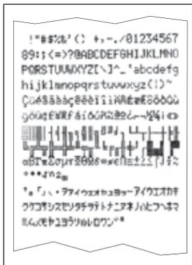
RS-P42 は自己テスト機能を備えており、自動的にプリント内蔵の文字セットをプリントアウトします。
