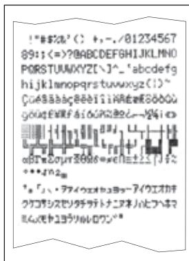
Der RS-P42 besitzt einen Selbst-Test, der automatisch den Zeichensatz des Druckers ausdruckt.
