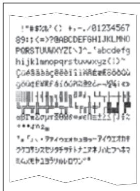
La RS-P42 è dotata di un self-test che stampa automaticamente i caratteri presenti sulla stampante.
