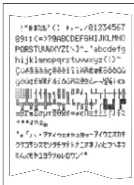
La impresora RS-P42 está equipada con una prueba de impresión que imprime automáticamente el carácter ajustado a la impresora.
