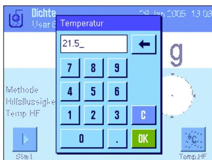
Wenn Sie **Wasser oder Ethanol als Hilfsflüssigkeit** verwenden, geben Sie deren **Temperatur** über die Funktionstaste "**Temp. HF**" ein (für diese beiden Flüssigkeiten sind Dichtetabellen für den Temperaturbereich von 10 °C bis 30 °C in der Waage gespeichert, siehe auch Kapitel 10.7 und 10.8). Die nebenstehende Abbildung zeigt das entsprechende Eingabefeld (Eingabe in °C mit 1 Nachkommastelle).
