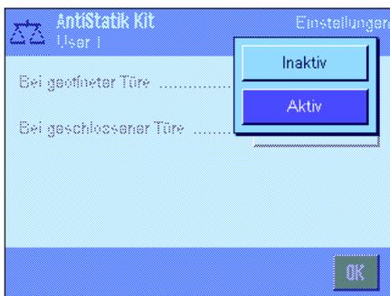
**"Bei geöffneter Türe":** Hier legen Sie fest, ob ionisiert werden soll, wenn der Glaswindschutz geöffnet ist ("Aktiv") oder ob keine Ionisierung stattfinden soll ("Inaktiv"). Mit der Einstellung "Aktiv" wird nach dem Öffnen des Windschutzes permanent ionisiert bis der Windschutz (Türen) wieder geschlossen werden (maximal 10 Minuten).
