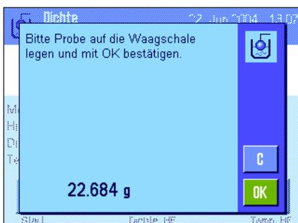
Drücken Sie die Funktionstaste "**Start**", um die Dichtebestimmung zu starten. Die Waage führt eine automatische Trierung durch und anschliessend werden Sie aufgefordert, den Festkörper aufzulegen (Wägung in Luft).
