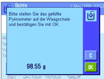
Drücken Sie die Funktionstaste **"Start"**, um die Dichtebestimmung zu starten. Anschliessend werden Sie aufgefordert, das gefüllte Pyknometer aufzulegen (das gewählte Gewicht des Pyknometers erscheint in der linken unteren Ecke des Fensters mit negativem Vorzeichen).
