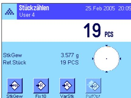
Fahren Sie mit der Stückzählung fort und legen Sie weitere Stücke auf. Um die Referenz zu optimieren, drücken Sie die Funktionstaste "**Ref.Opt**". Die aufliegende Stückzahl wird jetzt als neue Referenzstückzahl verwendet und das Referenzstückgewicht wird auf dieser Basis neu berechnet.
