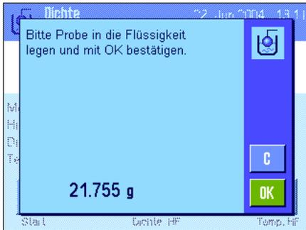
Das Wägeresultat wird gespeichert und anschliessend werden Sie aufgefordert, den Festkörper in die Hilfsflüssigkeit zu tauchen.
