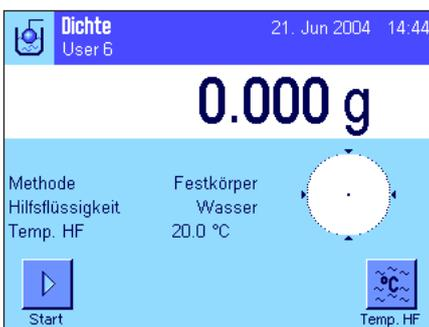
Nach dem Anwählen der Applikation erscheint die nebenstehende Anzeige. Ab Werk sind spezielle Funktionstasten und Infofelder für die Dichtebestimmung aktiviert. Die Waage ist für die Dichtebestimmung von Festkörpern unter Verwendung der Hilfsflüssigkeit Wasser voreingestellt. Diese Einstellungen können Sie an Ihre Bedürfnisse anpassen, gemäß der Beschreibung in den folgenden Kapiteln.
