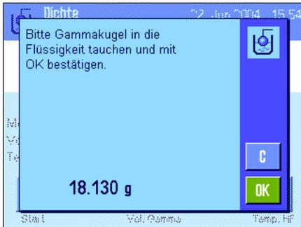
Nach der Tarierung der Probe werden Sie aufgefordert, die Gammakugel in die Proben-substanz einzutauchen.
