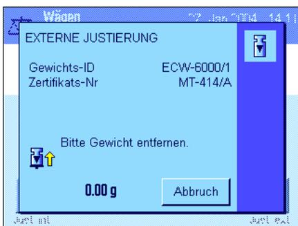
Nachdem Sie das verlangte Gewicht aufgelegt haben, wird der Justiervorgang automatisch fortgesetzt. Am Ende des Justiervorgangs werden Sie aufgefordert, das Gewicht abzuheben. Entfernen Sie das Justiergewicht von der Waagschale.
