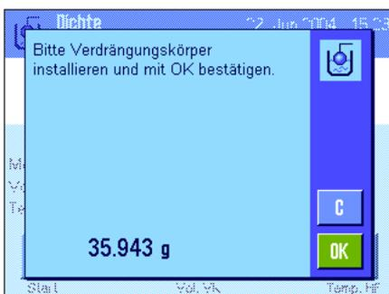
Drücken Sie die Funktionstaste "Start", um die Dichtebestimmung zu starten. Sie werden aufgefordert, den Verdrängungskörper zu installieren (Wägung in Luft zur Trierung).
