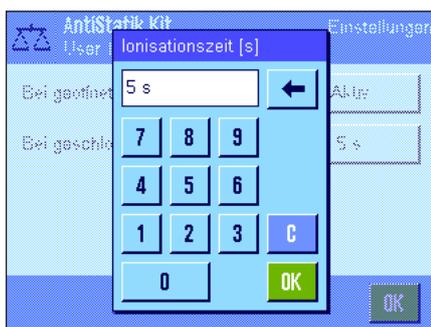
**"Bei geschlossener Türe":** Diese Einstellung bestimmt, für wie viele Sekunden nach dem Schliessen des Windschutzes (Türen) ionisiert werden soll (Einstellbereich 0 ... 1000 Sekunden). **Hinweis:** Wenn Sie die Zeitdauer auf "0" Sekunden setzen, findet nach dem Schliessen des Windschutzes (Türen) keine Ionisierung statt.
