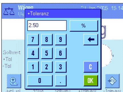
Mit den beiden Funktionstasten "**+Toleranz**" und "**-Toleranz**" können Sie festlegen, mit welcher Genauigkeit Sie wägen wollen. Das Eingabefenster gleicht demjenigen für den Sollwert. Ab Werk sind beide Toleranzwerte auf 2.5 % eingestellt. Anstelle eines prozentualen Wertes können Sie auch eine absolute Toleranz in einer beliebigen Einheit (z.B. "g") eingeben. Nach Eingabe des entsprechenden Wertes drücken Sie "**OK**", um die Toleranz zu aktivieren.
