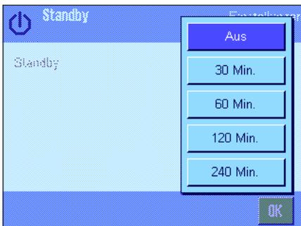
Sie können die Energiesparfunktion ausschalten (“Aus”) oder eine Zeit von 30, 60, 120 oder 240 Minuten festlegen, nach der die Waage in den “Standby”-Modus wechseln soll. Der “Standby”-Modus entspricht dem Zustand, in dem sich die Waage nach dem Ausschalten mit der Taste **«On/Off»** befindet. Zum Wiedereinschalten der Waage ist die Taste **«On/Off»** zu drücken.
