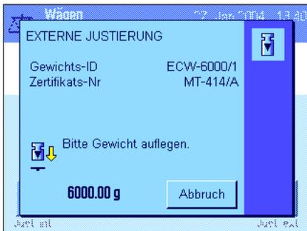
Nach dem Starten des Justiervorgangs werden Sie aufgefordert, das Justiergewicht aufzulegen. Falls vorhanden, werden die ID und die Zertifikatsnummer des entsprechenden Gewichtes angezeigt. Der geforderte Gewichtswert wird am unteren Rand des Fensters blinkend dargestellt.
