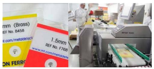
Per ciascun turno di produzione di 8 ore, i rivelatori di metalli vengono testati cinque volte.
