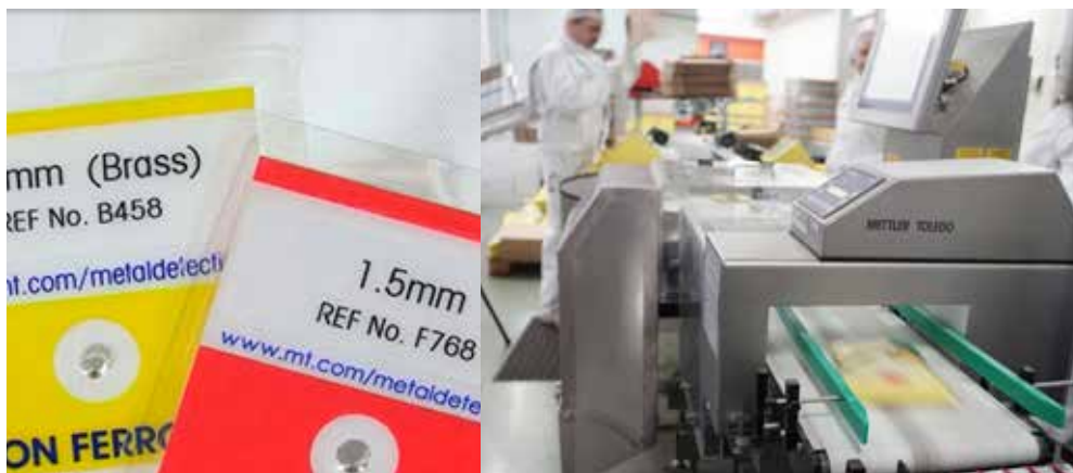
Металлодетекторы проходят проверку пять раз в течение каждой 8-часовой производственной смены.
