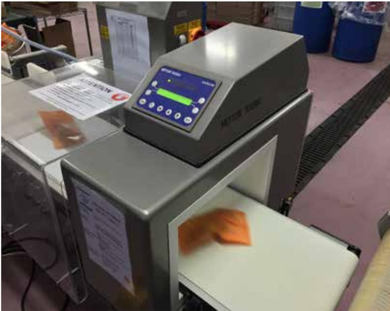
Los puntos de control críticos (PCC) instalados en las líneas comprueban todos los envases en busca de contaminación por metales para garantizar la seguridad de los productos de acuerdo con la norma IFS.
