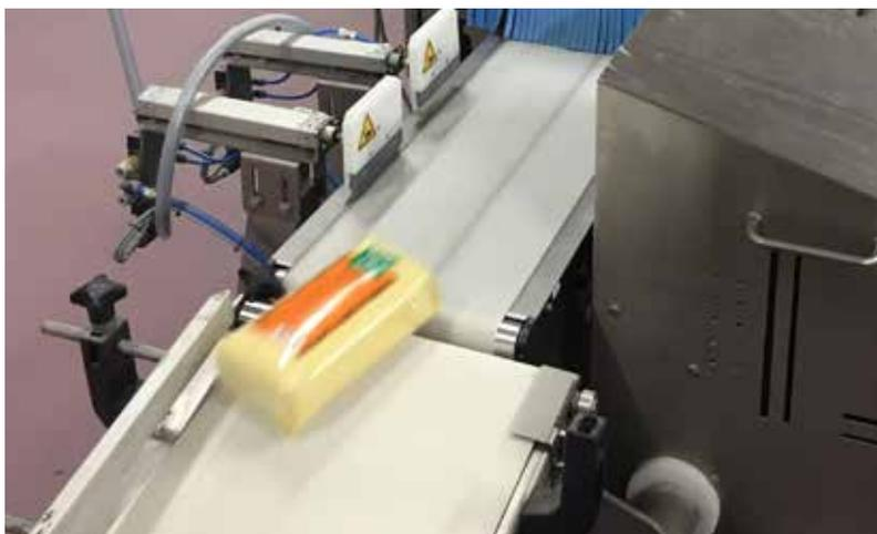
Los productos no conformes se rechazan de inmediato hacia unos contenedores de retención. Los motivos de rechazo son la presencia de cuerpos extraños (como madera, plásticos, piedras y metales) y las discrepancias en el peso. El sistema combinado de METTLER TOLEDO gestiona de manera fiable todos los tipos de rechazos.
