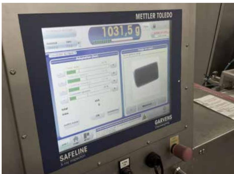
L'interface utilisateur du logiciel du système combiné affiche à la fois les résultats du pesage et de l'inspection par rayons X.
