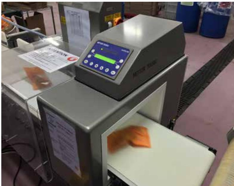
Sur les lignes, des points de contrôle critiques (CCP) vérifient l'absence de contamination métallique dans tous les emballages pour garantir la sécurité des produits conformément aux directives IFS.
