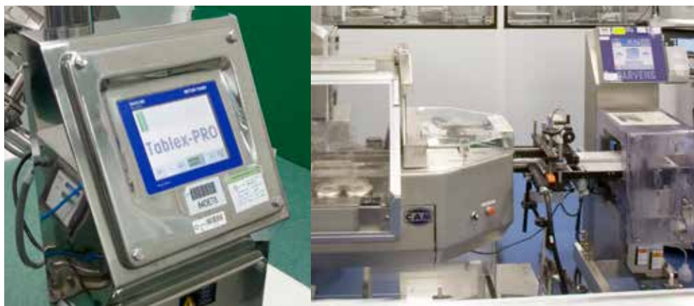
Toblex-Pro (hình bên trái) kiểm tra tất cả các viên thuốc và loại bỏ nó nếu phát hiện các tạp chất kim loại. Sau giai đoạn đóng gói đầu tiên, cân băng tải sẽ kiểm tra một cách đáng tin cậy về sự hoàn chỉnh của từng gói (hình bên phải).
