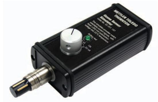
Die Inbetriebnahme von Geräten zur Ozonmessung von Mettler-Toledo Thornton kann mit dem Einsatz des Ozonsensor-Simulators deutlich beschleunigt werden. Der Simulator wird anstelle des Sensors angeschlossen und liefert Signale für Ozon und Temperatur, ohne dass der Sensor erst langwierig ozonisiert oder polarisiert werden muss. Mit dem Simulator kann das Messsystem (bis auf den Sensor selbst) vor Inbetriebnahme der Ozonmessung geprüft werden.
