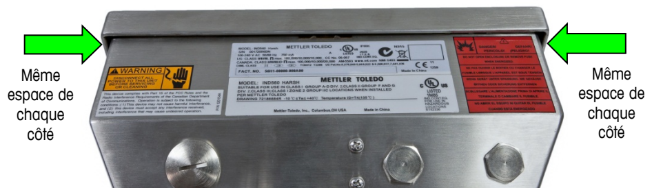
Figure 2-6 : Centrage du couvercle avant sur le boîtier arrière
