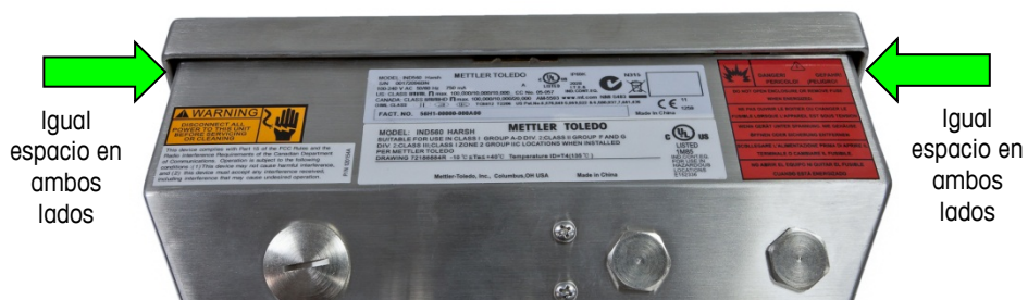
Figura 2-6: Centrado de la cubierta frontal en la caja posterior
