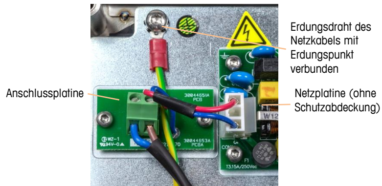
Abbildung 2-18: IND236 – Netzplatine und Erdung
