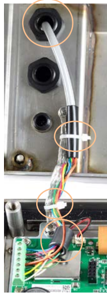
Figura 2-28: Conexión a tierra de la patilla de la celda de carga analógica e instalación de la ferrita, IND236
