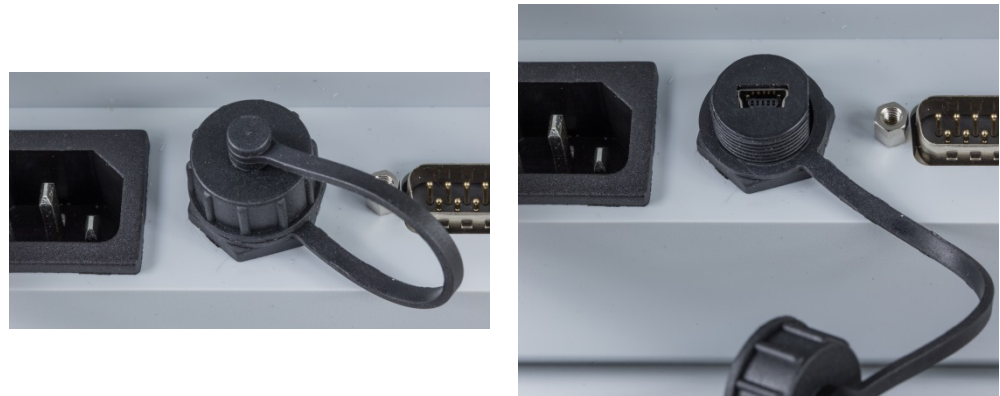
Abbildung 2-39: Mini-USB-Anschluss und Abdeckung
