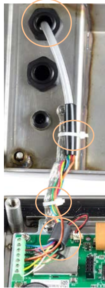
Figura 2-28: Instalação de Ferrite e Pino Terra da Célula de Carga Analógica, IND236
