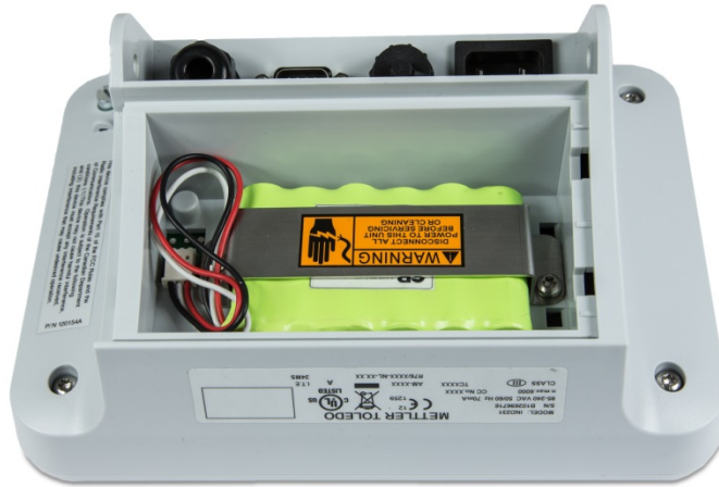
Abbildung 2-21: Im Terminal IND231 eingesetzte NiMH-Batterie
