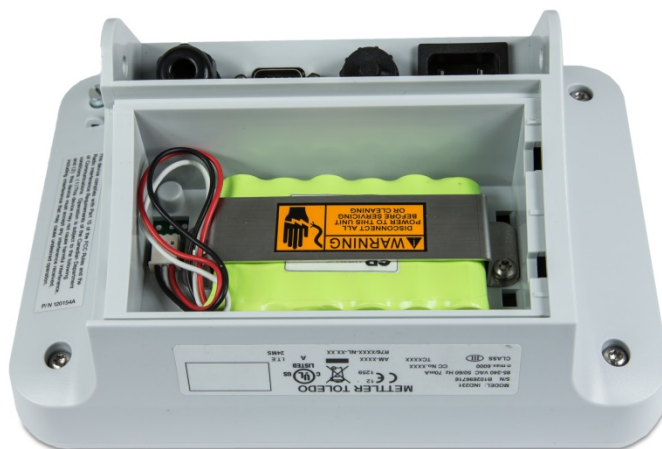
Figure 2-21: Batterie NiMH installée dans l'IND231
