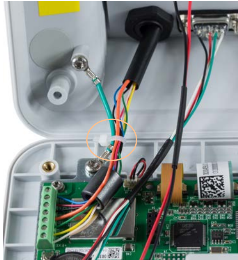
Figura 2-24: Conexión a tierra de la patilla de la celda de carga analógica e instalación de la ferrita, IND231
