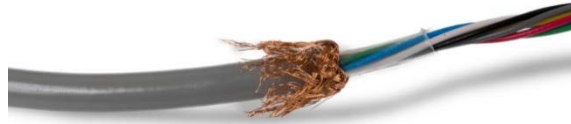
Figura 2-30: Cavo della cella di carico dopo aver ripiegato il filo di schermatura
