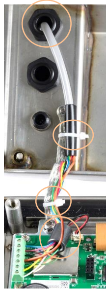
Abbildung 2-28: Stifferung der analogen Wägezelle und Ferritperleninstallation, IND236
