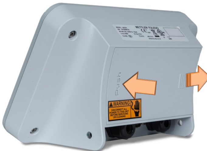
Figure 2-19: Remplacez le couvercle de la batterie
