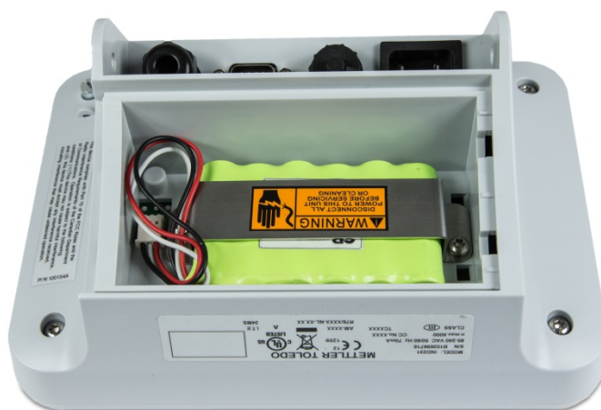
Figura 2-21: Batteria NiMH Installata in IND231
