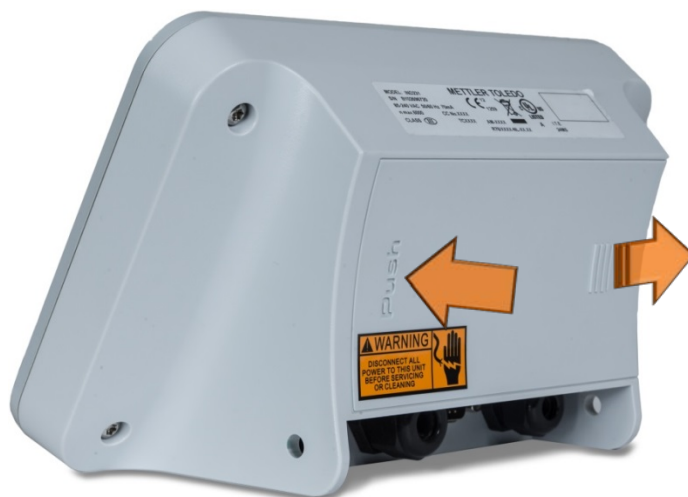
Figura 2-19: Remover a tampa da bateria
