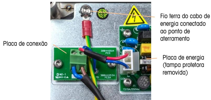
Figura 2-18: Placa de conexão de energia CA e aterramento do IND236
