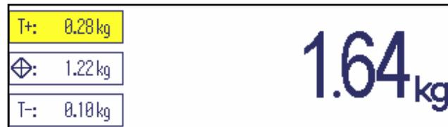
Toleranzen und Sollgewicht werden in 3 Zeilen angezeigt. Im Beispiel wird die Standardfarbe für Wägegut angezeigt, das über der oberen Toleranzgrenze liegt.
