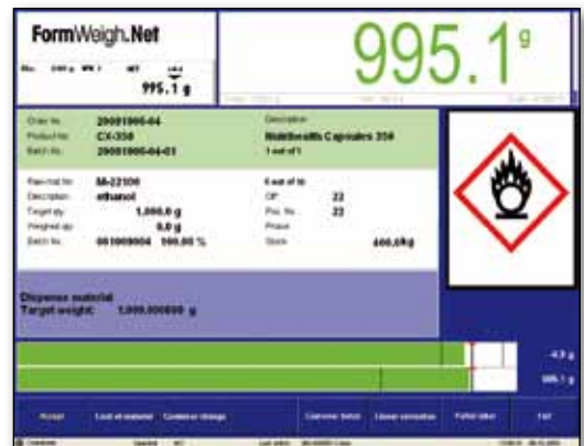
Der Echtzeit-Fortschrittsbalken ist für den Bediener gut sichtbar und wechselt je nach Wägefortschritt die Farbe.
