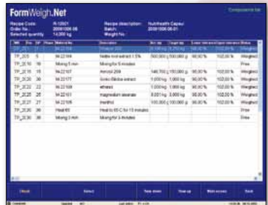
Die Komponentenliste an der Wägestation zeigt die Reihenfolge der Rezepturkomponenten und die entsprechenden Arbeitsanweisungen an.
