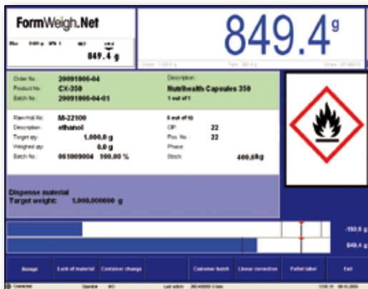
Die Wägesoftware FormWeigh.Net® zeigt alle wichtigen Komponenteninformationen auf einen Blick, dies schließt auch Piktogramme wie z.B. Gefahrensymbole ein.
