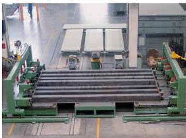
Der Stahl der VTC205 ist kugelgestrahlt, dies gewährleistet eine optimale Lackierung
