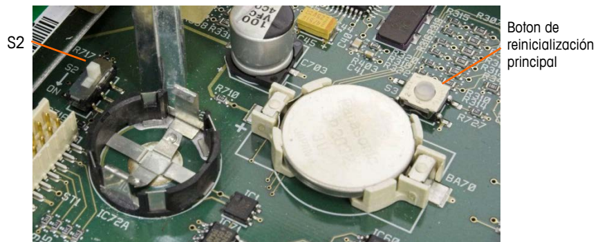
Figura 2-36: Ubicación del botón principal de reinicialización del PCB principal
