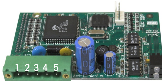
Figura 2-75: Numeración de patillas de la tarjeta opcional DeviceNet
