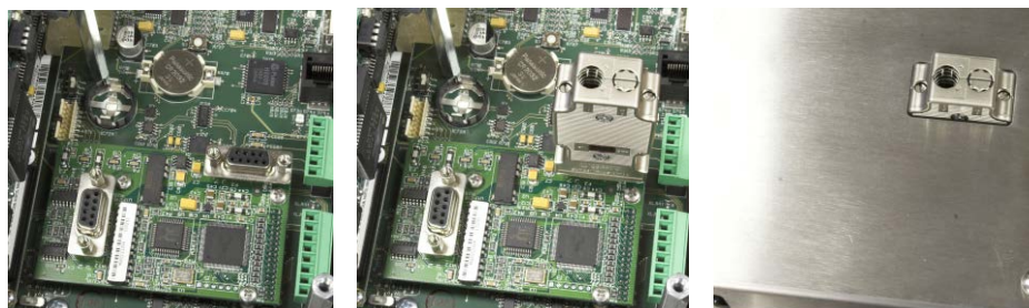
Figura 2-80: Conector de módulo de PLC PROFIBUS para caja para montaje en panel
