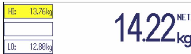
Las tolerancias y el peso teórico se indican en 3 líneas. El ejemplo muestra el color estándar para una muestra por encima de la máxima tolerancia.
