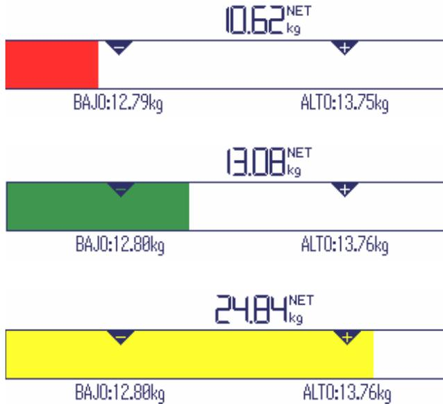
**Display para Encima/Debajo del control de peso y tipo de tolerancia "Relativo"**
