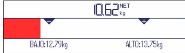
En lugar del display de peso se muestra un gráfico de barras indicando los valores finales. El ejemplo muestra el color estándar para una muestra por debajo de la mínima tolerancia.
