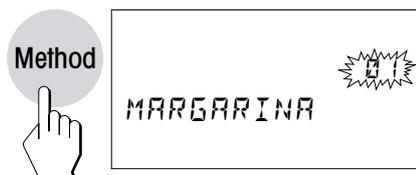
Pulse la tecla «Method». En el indicador aparece el número de método fijo (01-40) parpadeante y la designación del método activado en cada momento.
