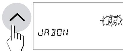
Con las teclas «Aumentar» y «Disminuir» puede seleccionar el método deseado. A continuación pulse la tecla «Enter (Entrada aceptada)». No obstante, también puede introducir directamente el número de método en el campo numérico.
