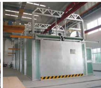
La VTC205 está pintada con acrílica de poliuretano y tratada térmicamente para evitar la corrosión
