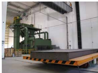
La VTC205 está recubierta antes de aplicar la primera capa de pintura
